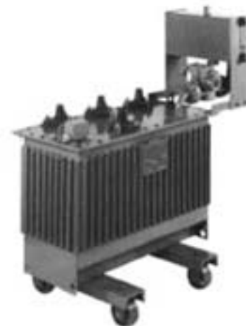
Fig. 1: bobina zigzague ou de ponto neutro, constitui uma reatância de limitação das correntes de falha a terra.
